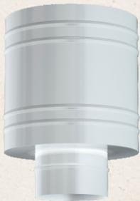
O chapéu Canhão é fabricado em **Inox 430**, **inox 304** ou **Aço Galvanizado**. Utilizado no topo de tubos para realizar a proteção contra entrada de pequenas aves e água de chuvas com correntes de ventos horizontais. Seu formato cônico juntamente com o fechamento lateral auxilia na dispersão da fumaça pela parte inferior e superior do chapéu.
